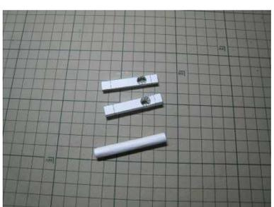
A photograph showing three white frame components and a white pipe, all on the grid background.                                                                                           | 1) フレームf10c、f10dに取り付ける動力ゴムを貼るためのパイプφ8-φ6-50を作ります。                 |
